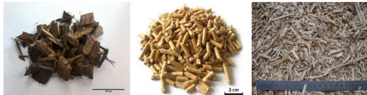
Abbildung 4: Beispiele für Holz hackschnitzel (Agrivalor, links), Holzpellets (DIN+, Mitte) und getrockneten, gehäckselten Miscanthus (rechts).
